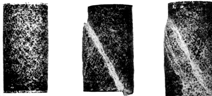
รูป 4.47 ลักษณะแท่งตัวอย่างที่เกิดรอยเลื่อนในหินปูน รูปซ้าย-สภาพก่อนเปลี่ยนลักษณะ รูปกลาง-สภาพเกิดรอยเลื่อนหนึ่งรอย รูปขวา-สภาพเกิดรอยเลื่อนถี่ๆ (Davis & Reynolds, 1996)
