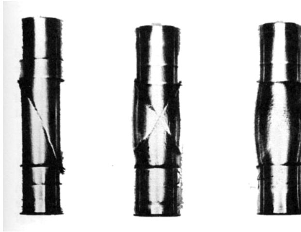
รูป 4.34 การวิบัติของแท่งหินจากการทดสอบความแข็งแรงในห้องปฏิบัติการ โครงสร้างหิน สังเกตจากปลอกทองแดงผนังบางที่ห่อหุ้มตัวหิน ภาพซ้ายเป็นการวิบัติหรือรอยเลื่อนในหินขนวน ภาพกลางเป็นรอยเลื่อนไขว้กัน ( conjugate fault ) ของหินทราย และภาพขวาเป็นการบิดย้วย ( ductile flow ) ก่อนเกิดการวิบัติในหินปูน (Davis & Reynolds, 1996)
