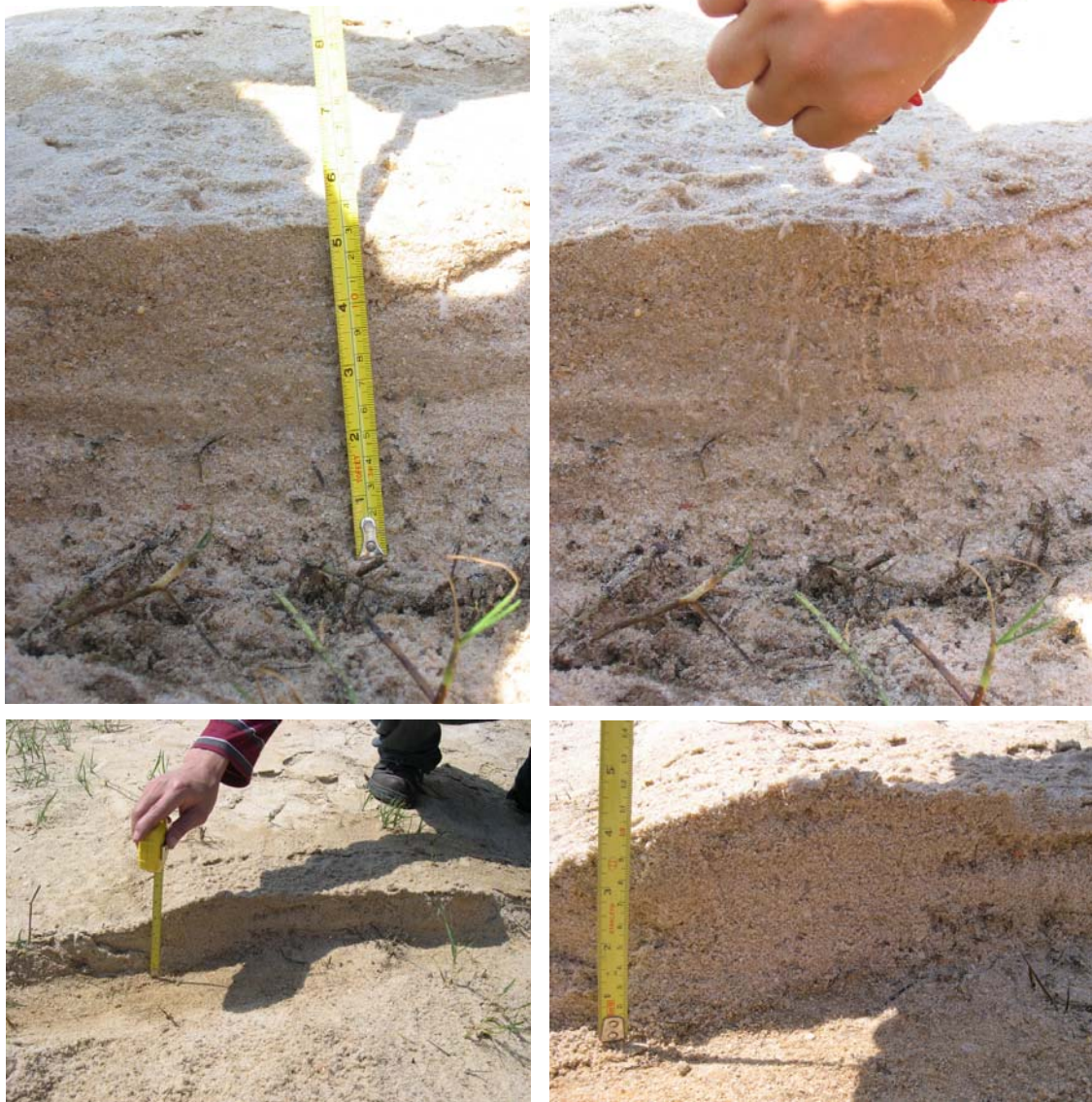
รูป 4.47 ภาพตัดขวางแสดงความหนาของตะกอนสีนํามีที่วัดได้จากแต่ละรูปแบบของลักษณะปรากฏบนพื้นผิว จะเห็นว่า ตะกอนสีนํามีที่มีรูปร่างพื้นผิวที่เป็นเนินทราย ( bedform dunes ) จะมีความหนาอยู่ในช่วง 10-12 เซนติเมตร และมีมุมเอียงทางด้านชันน้อย ( stoss angle ) ระหว่าง 20 ถึง 30 องศา และมีมุมเอียงทางด้านชันมาก ( lee angle ) ระหว่าง 2-5 องศา ซึ่งการวัดขนาดความยาวของแต่ละสันทราย ( wavelength ) ความสูงของยอดสัน ( height ) มุมเอียงเททั้งสองด้าน ประมวลผลร่วมกับการวิเคราะห์ขนาดตะกอน ( grain size analysis ) จะสามารถคำนวณความเร็ว (ความเร็วที่ระดับฐานของการพัดพา หรือ ความเร็วต่ำสุด) และ ความสูงของกระแสน้ำทะเลจากการพัดพาโดยสีนํามีได้
