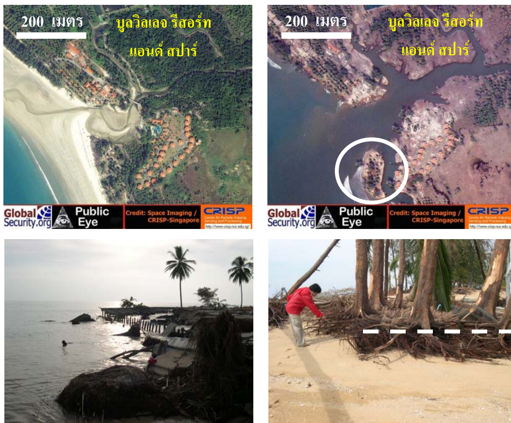
รูป 4.64 ภาพดาวเทียม IKONOS ขยายให้เห็นพื้นที่การกัดเซาะชายฝั่งบริเวณตอนล่างของแหลมปะการัง ปากคลองที่ตั้งบูลิวเลจ รีสอร์ท แอนต์ สปาร์ การกัดเซาะเกิดขึ้นอย่างรุนแรงทำให้ปากคลองเปิดกว้างขึ้น และแนวสันทรายเดิม (ในตำแหน่งวงกลม) ได้ถูกกัดเซาะจนเกิดเป็นลักษณะเกาะสันดอน ซึ่งแสดงให้เห็นปริมาณตะกอนได้สูญเสียบ่อยอย่างชัดเจน (ระดับเส้นประสีขาว ดังแสดงในรูปถ่ายด้านล่าง บันทึกภาพเมื่อ 7 มกราคม 2548) (ข้อมูลภาพดาวเทียมจากโฮมเพจของ CRISP)
