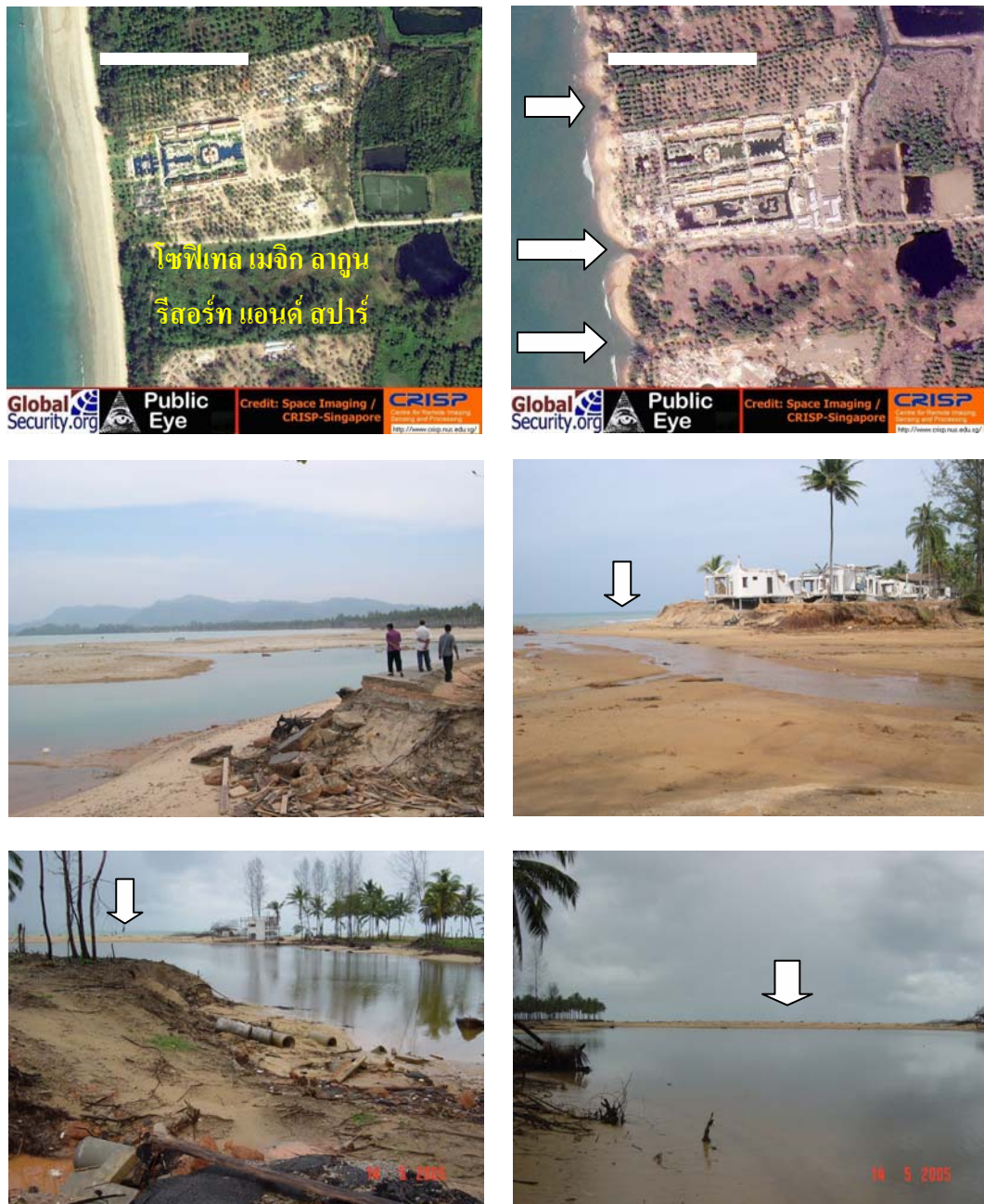
รูป 4.65 ภาพดาวเทียม IKONOS ก่อนและหลังสึนามิในบริเวณโซฟีเทล เมจิก ลาгуน บ้านก๊กัก จังหวัดพังงา (ข้อมูลภาพจากโฮมเพจของ CRISP) จะเห็นการกัดเซาะบริเวณหน้าหาดชัดเจน (ตำแหน่งที่ลูกศรชี้) และสองรูปภาพกลาง แสดงพื้นที่ที่ถูกกัดเซาะจากการสำรวจภาคสนาม เมื่อวันที่ 8 มกราคม 2548 ส่วนสองรูปล่างแสดงการฟื้นตัวของตะกอนที่มาปิดกั้นปากคลองในบริเวณใกล้เคียง บันทึกภาพเมื่อวันที่ 14 พฤษภาคม 2548
