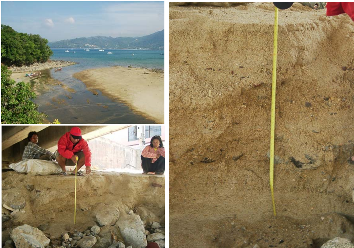
รูป 4.55 ภาพถ่ายมุมสูงจากคลองปากบางแสดงให้เห็นตะกอนบางส่วนได้สูญหายในบริเวณปากคลอง (รูปบนซ้าย บันทึกภาพขณะน้ำทะเลลงต่ำสุด เมื่อวันที่ 4 มกราคม 2548) และตะกอนเดิมที่ถูกคลื่นกัดเซาะบริเวณใต้สะพานคลองปากบาง (รูปล่างซ้ายขวา) จะเห็นว่า การเคลื่อนย้ายตะกอนคลื่นในบริเวณปากคลองเป็นไปในปริมาณมากกว่าบริเวณหน้าหาด
