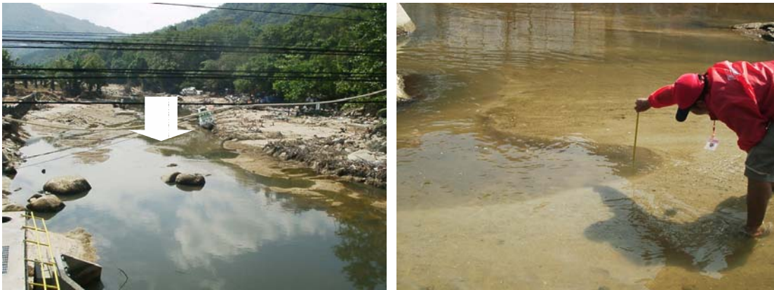
รูป 4.53 ลักษณะตะกอนที่เป็นเนินทรายใต้น้ำ (submerge dune sands) พบในบริเวณคลองปากบางมีขนาดความยาวช่วงคลื่นประมาณ 2.50 เมตร แสดงทิศทางการเคลื่อนตัวของสีนํามีทั้งเข้าไปในแผ่นดินและออกสู่ทะเล ตำแหน่งลูกศรชี้ในภาพด้านซ้ายเป็นบริเวณที่ทำการวัดขนาดเนินทรายใต้น้ำในรูปด้านขวา (ภาพเมื่อวันที่ 4 มกราคม 2548 บันทึกขณะน้ำทะเลลงต่ำสุด)
