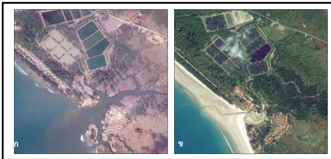
รูป 3.16 ภาพจากดาวเทียม อิโคนอส (IKONOS) คลองพรุไทร (ก) วันที่ 13 มกราคม พ.ศ. 2546 และ (ข) วันที่ 29 ธันวาคม พ.ศ. 2547 ปากแม่น้ำกว้างออกเนื่องจากคลื่นเคลื่อนที่เข้าหาฝั่งอย่างรวดเร็วด้วยพลังการกัดเซาะที่มากมาย บริเวณคลองพรุไทร บ้านบางขะ ต. กีกัก อ. ตะกั่วป่า จ. พังงา (ที่มา: www.crisp.nus.edu.sg/tsunami/ )
