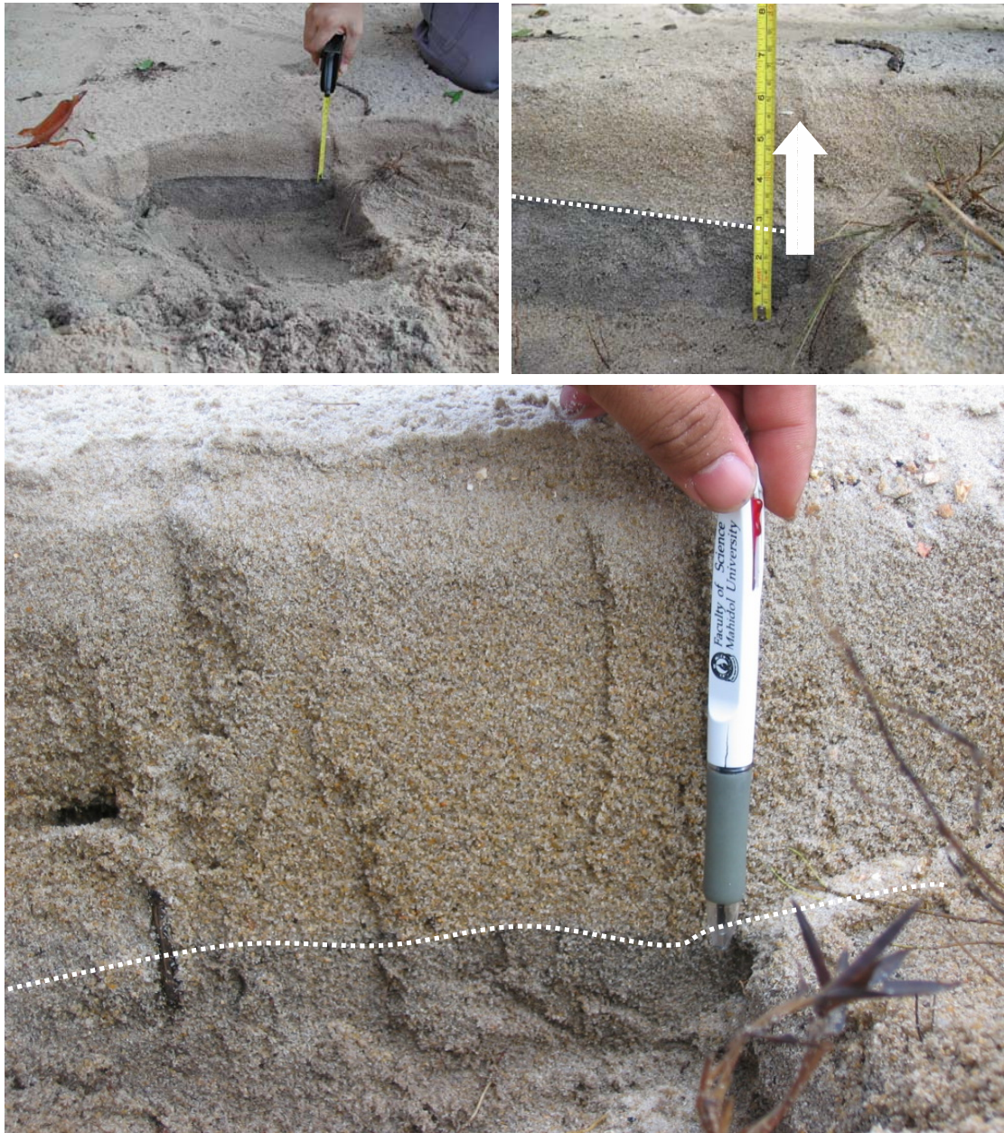
รูป 4.40 ภาพหน้าตัดของตะกอนสีนํามี (สีเทาเหลืองด้านบนที่ลูกศรสีขาวชี้) ที่พบในบริเวณหาดไม้ขาว มีความหนาอยู่ในช่วง 5-10 เซนติเมตรปิดทับอยู่บนตะกอนสีนํมทรายเดิม (สีเทาดำด้านล่าง) แนวจุดประสีขาวเป็นเส้นแบ่งชั้นตะกอนสีนํมกับตะกอนเดิม
