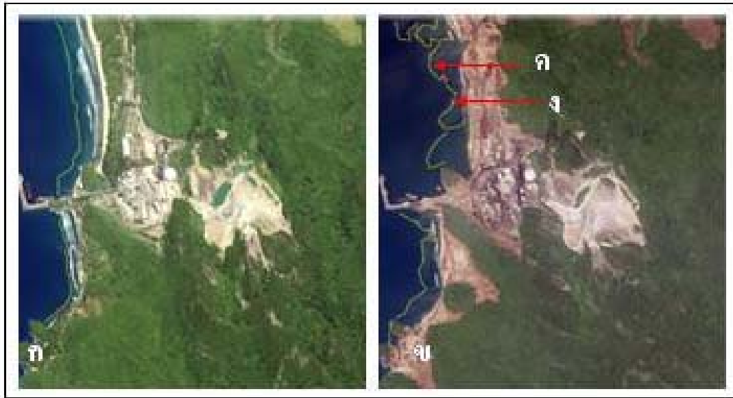
รูป 3.17 (ก) ภาพก่อนการเกิดสึนามิบริเวณแหลมปะการัง ต. คีตก อ. ตะกั่วป่า จ. พังงา ถ่ายไปทาง ตะวันออกเฉียงเหนือ (ที่มา: www.thai-tour.com/thai-tour/South/Pangnga/data/place/kaolak/attractions.html ) (ข) ภาพหลังการเกิดสึนามิบริเวณเดียวกัน ภาพย้อนทางไปยังทิศตะวันตกเฉียงเหนือ แสดงผลการกัดเซาะที่ทำให้ลักษณะทางกายภาพและภูมิลักษณะโดยรวม(coastal landforms) เปลี่ยนแปลงไปอย่างมาก (ภาพโดย ภาควิชาธรณีวิทยา คณะวิทยาศาสตร์ จุฬาลงกรณ์มหาวิทยาลัย)
