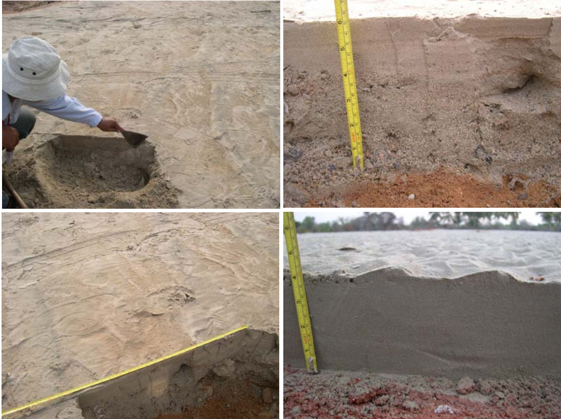
รูป 4.35 ภาพตัดขวางแสดงหน้าตัดชั้นตะกอน จะเห็นว่า ตะกอนมีการคัดขนาดจากใหญ่ขึ้นไปเล็ก ( fining upward ) และในบางพื้นที่พบการสะสมตัวเป็นสองชั้นที่มีชุดการคัดขนาดสองชุด ( double-layered fining upward sequences ) การขุดร่องสำรวจและการทำรายละเอียดชั้นตะกอนสีนํามีในระดับโครงสร้างตะกอน จะช่วยให้สามารถคำนวณความเร็วและเปรียบเทียบความรุนแรงของสีนํามีได้ซึ่งจะได้กล่าวในหัวข้อ ความเร็วของสีนํามีต่อไป
