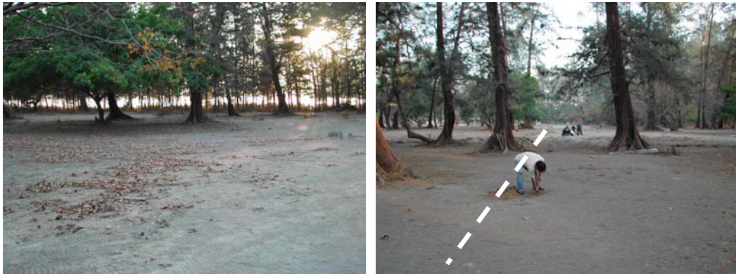
รูป 4.28 พื้นที่หาดบริเวณอุทยานแห่งชาติแหลมสนที่พบการกระจายตัวของตะกอนสึนามิเป็นระยะทางประมาณ 200 เมตร จากหน้าหาด รูปขวามือแสดงตำแหน่งการขุดร่องสำรวจเพื่อเก็บตัวอย่างตะกอน โดยมีระยะห่างระหว่างหลุมตัวอย่าง 50 เมตร แนวเส้นสีขาวแสดงแนวทิศทางตั้งฉากกับแนวชายฝั่ง (ข้อมูลภาพและการวิเคราะห์บางส่วนได้จาก Choowong และคณะ ปี 2005 Journal of Geological Society of Japan )
